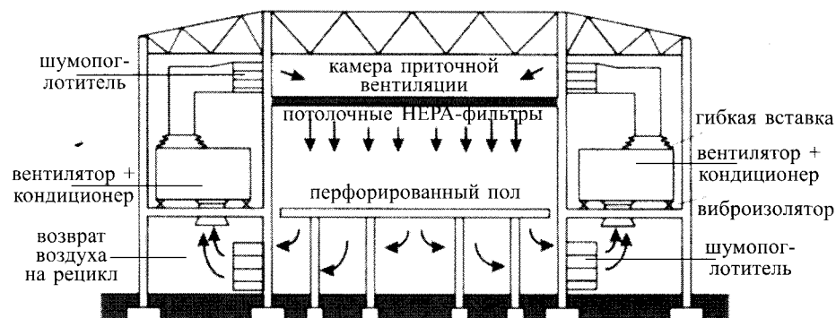
Рис. 6.5. Чистые помещения с односторонним потоком воздуха, часто используемые в производстве полупроводниковых приборов
