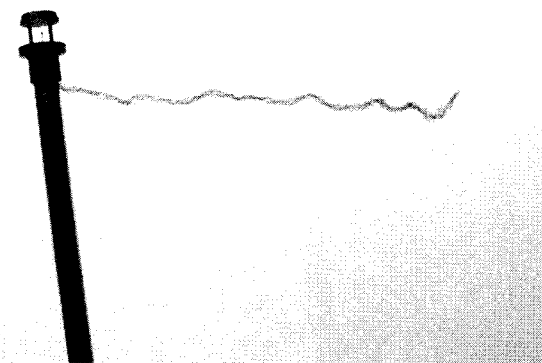
Рис. 11.2. Стример из нейлоновой нити, используемый совместно с анемометром
