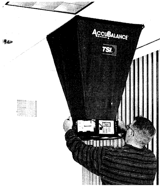
Рис. 10.1. Конусообразная насадка для измерения расхода воздуха
