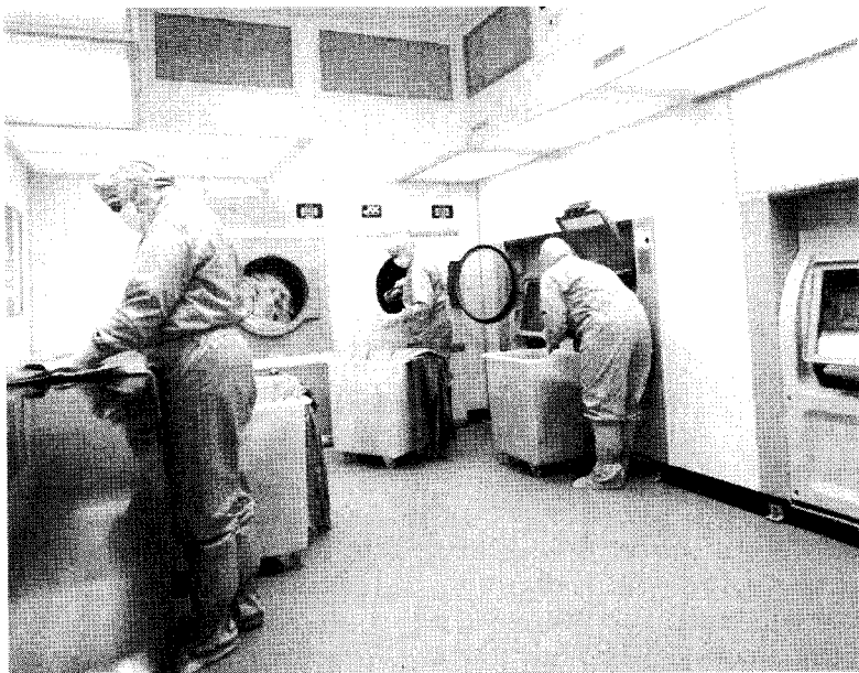
Рис. 19.11. Прачечная для одежды чистых помещений со стиральными машинами, барабанными сушилками и столом для складывания одежды
