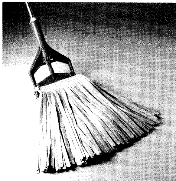
Рис. 21.4. Тип швабры, рекомендуемый для очистки пола чистого помещения
